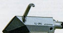
●徹底的な無共振化構造や3層ラミネート・コアのローリンピーダンス発電系などで伝送損失を大幅に低減。パワフルなクリーン・サウンドのシェル一体構造MM型です。同一のボディ仕様で振動系が異なっています。●構造=インテグレーテッドMM型 針型式=シバタ針(U-2型)/格内針(U-2E型) 出力=3.0mV(U-2型)/2.8mV(U-2E型) 周波数特性=10~50,000Hz(U-2型)/10~40,000Hz(U-2E型) 自重=17.5g 交換針=DT-U2型/DT-U2E型
